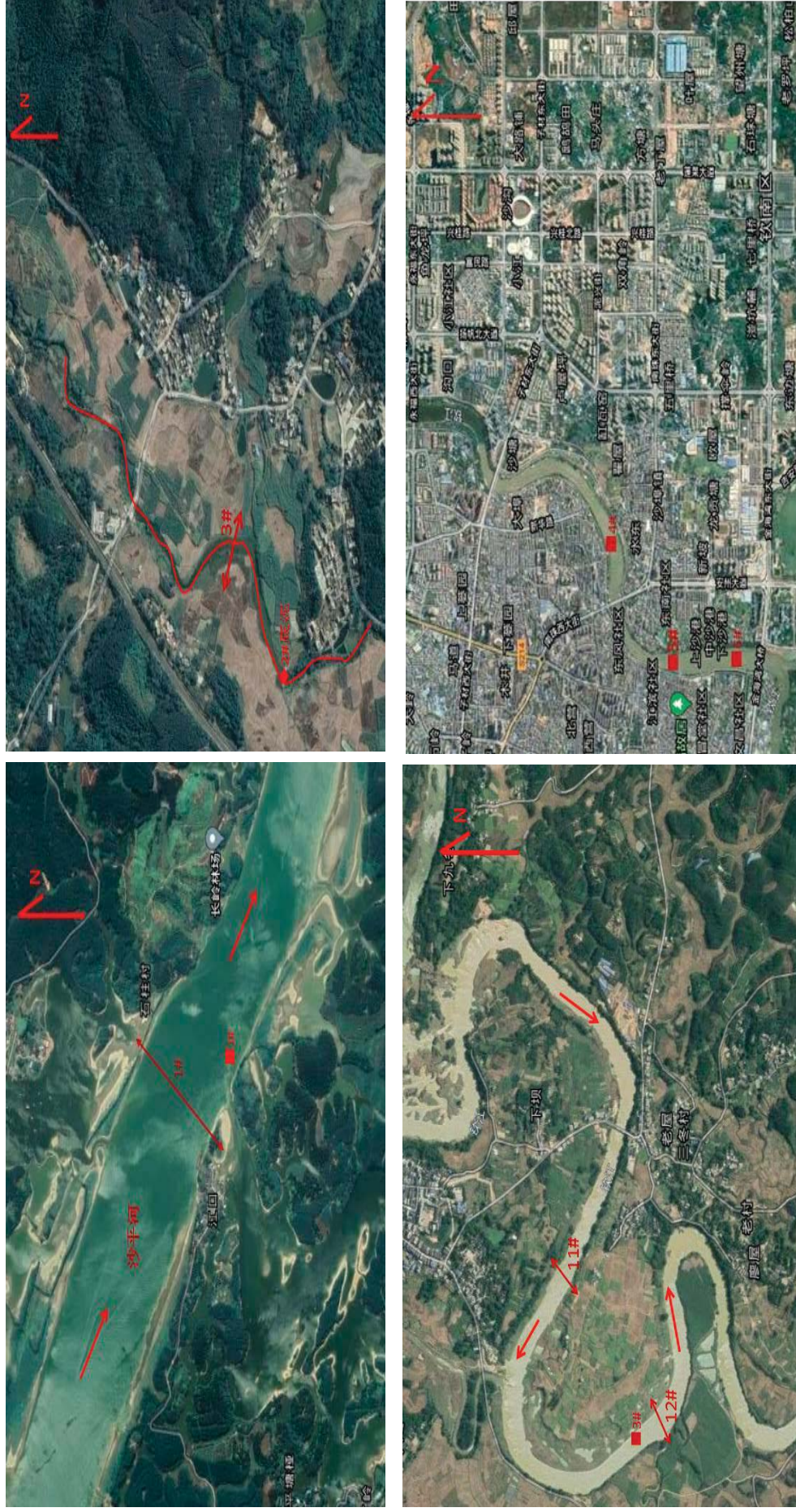
注：“↔”为地表水监测断面，“→”为水流方向，“■”为沉积物的监测点位 图 5.3.1-1 河道底泥监测点位位置示意图
