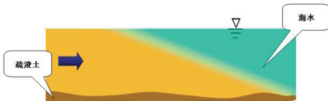
图 3.3.1-1 设置防污屏前悬浮泥沙扩散示意图
