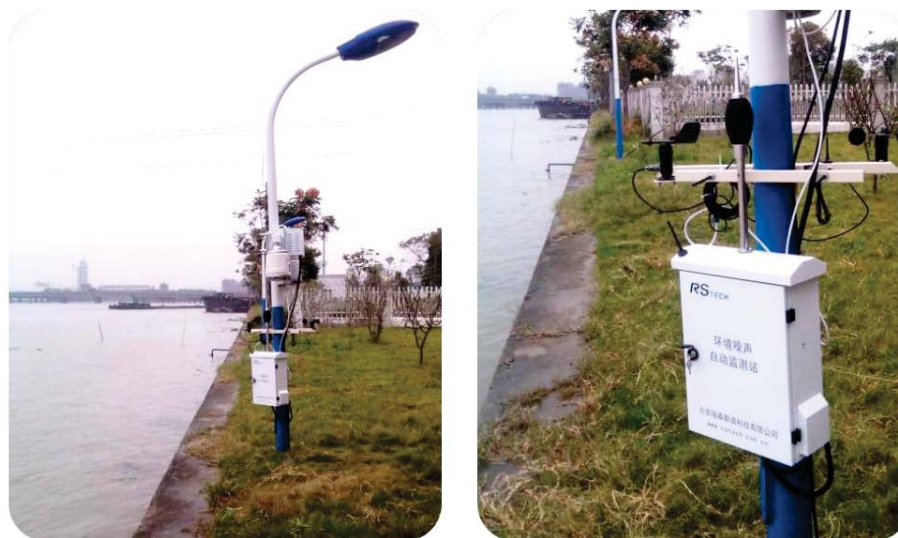
图 6.7.2-2 嘉兴某航道船舶噪声监测设备布置图
