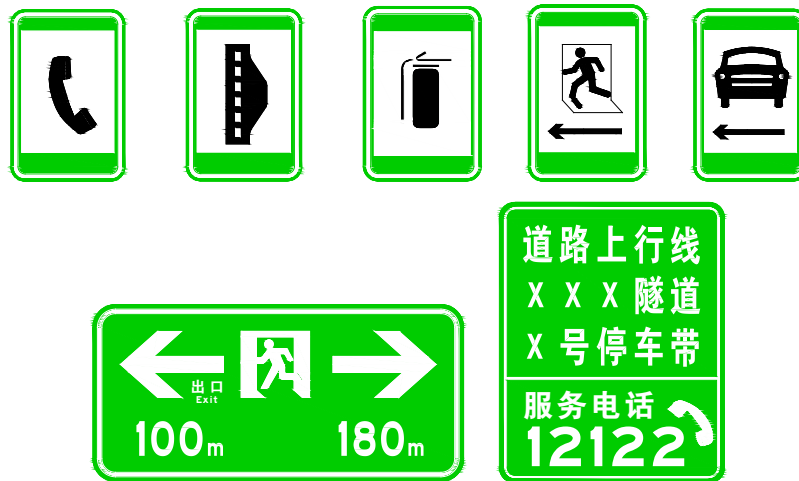
图52 隧道内指示标志版面设置示例
