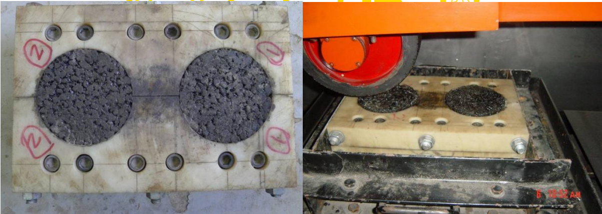
图B.7 构造深度耐久性试验专用夹具及轮碾试验
