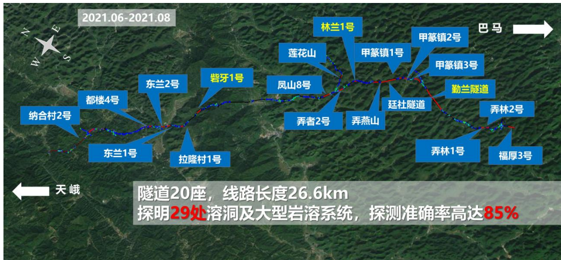
图 52 半航空瞬变电磁法在天巴高速隧道勘察应用情况
