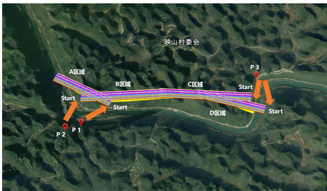
图 40 隧道勘探区域及航线规划
