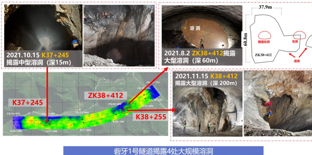
图 59 砦牙 1 号隧道岩溶揭露与探测结果对比
