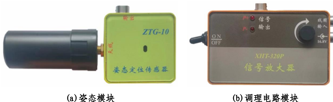
图 9 接收线圈姿态及调理电路模块实机
