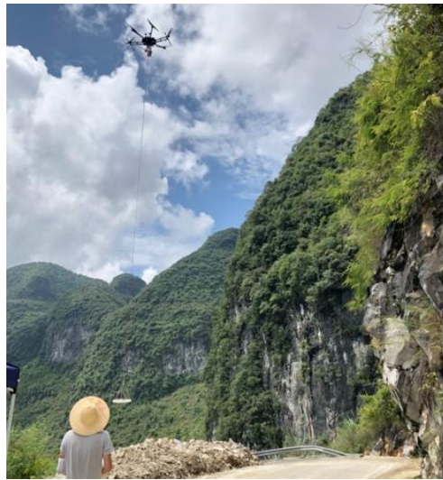
图 45 飞行平台搭载信号接收设备
